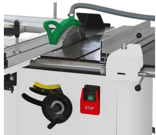
Abb. 22: Handrad für die Höhenverstellung des Sägeblatts
