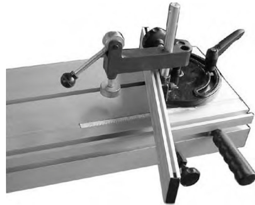
Abb. 40: Skalen für Gehrungsschnitte am Winkelanschlag
