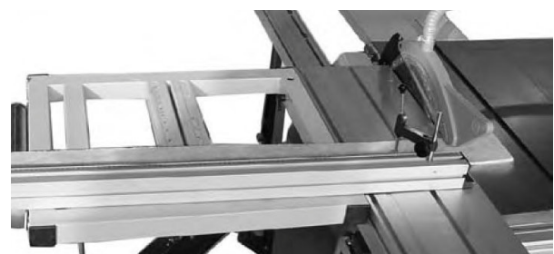
Abb. 36: Anschlag in hinterer Position für kleinere Werkstücke
