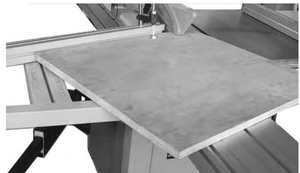
Abb. 41: Gehrungsschnitt mit Anschlag
