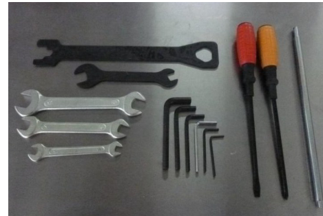
Abb. 7: Mitgeliefertes Werkzeug für FKS 315-2000 E
