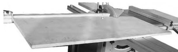
Abb. 35: Anschlag in vorderer Position für große Werkstücke
