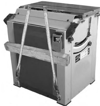
Abb. 9: Vorbereitung für den Transport
