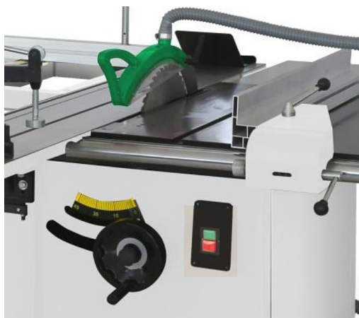
Abb. 43: Handrad für die Höhenverstellung des Sägeblatts
