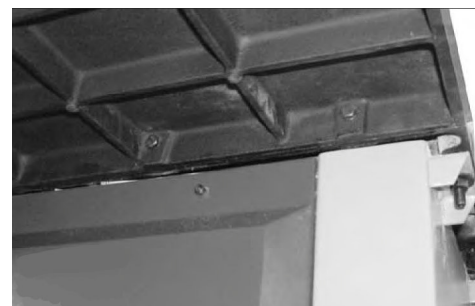
Abb. 10: Erweiterungstisch aus Gusseisen montieren
