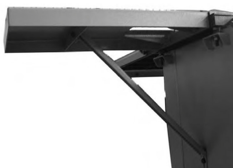
Abb. 13: Hinteren Erweiterungstisch anschrauben
