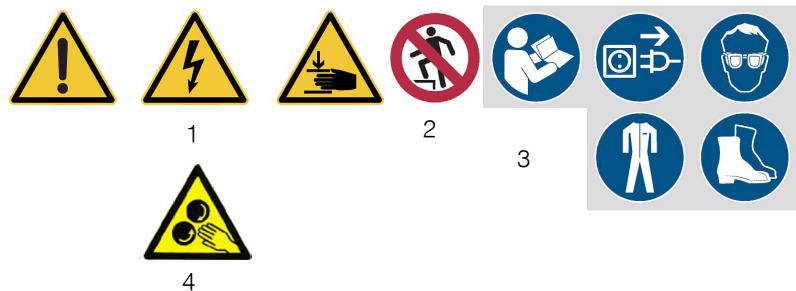
Abb. 1: Sicherheitskennzeichnungen - 1 Warnzeichen: Warnung vor gefährlicher elektrischer Spannung, Gefahr für Handverletzungen | 2 Verbotsschilder: Nicht betreten | 3 Gebotsschilder: Betriebsanleitung lesen, Netzstecker ziehen, Augenschutz, Sicherheitskleidung, Sicherheitsschuhe tragen | Warnzeichen: Quetschgefahr durch rotierende Walzen
