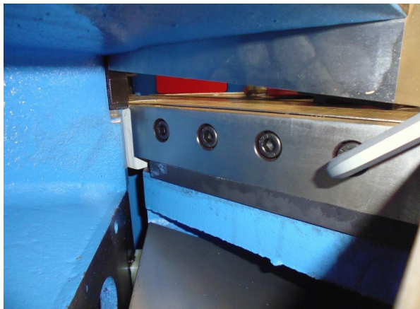
Abb. 21: Lösen der Schrauben des Untermessers
