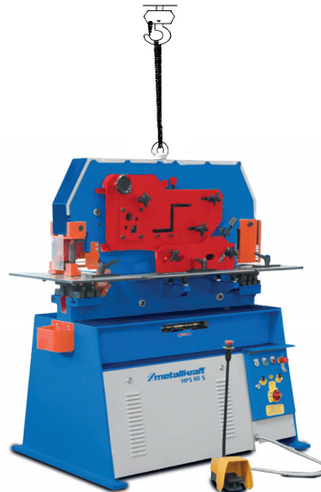
Abb. 4: Transportöse - Transport mit Kran
