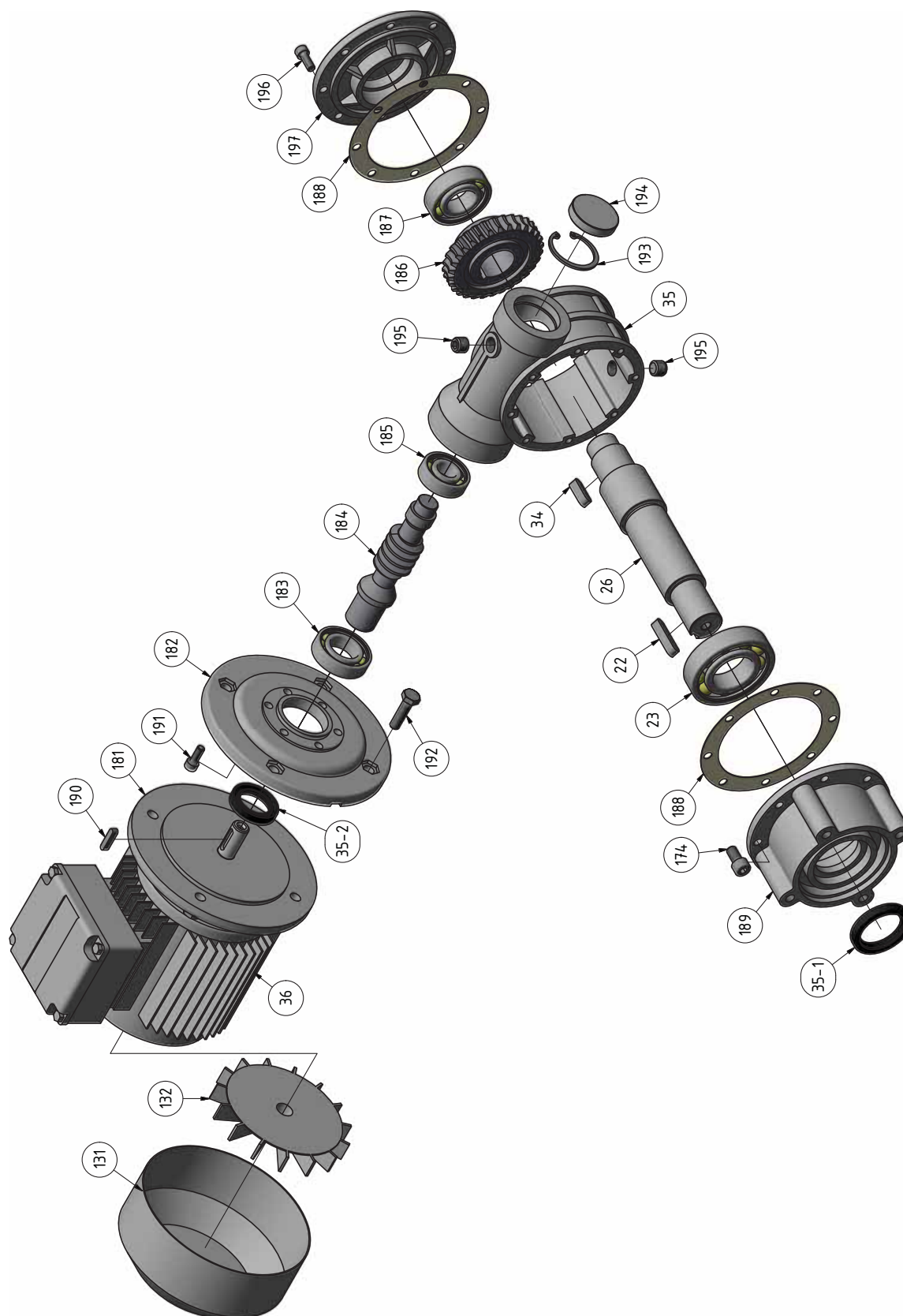
6-4: Getriebe - Gear box
