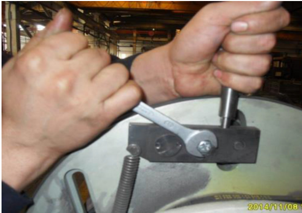
Abb. 26: Freigeben der Spannrolle
