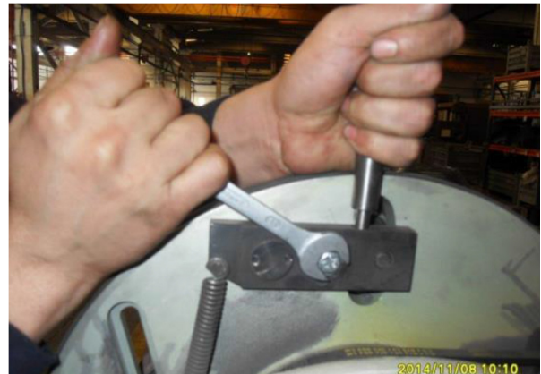
Abb. 12: Lose schrauben der Feineinstellungsrollen
