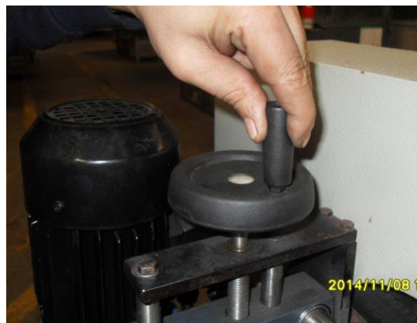
Abb. 18: Drehrad zur Einstellung der Höhe der Förderräder
