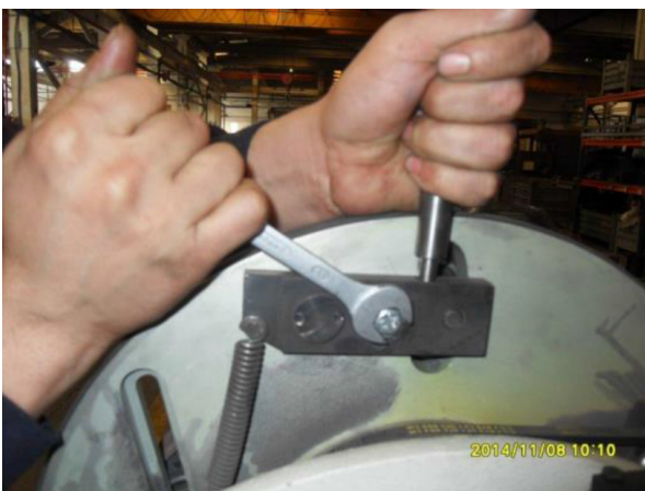
Abb. 16: Festschrauben der Spannrolle
