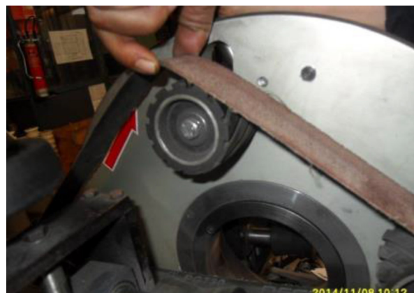
Abb. 25: Platzieren der neuen Spannbänder
