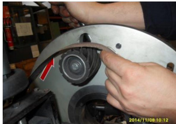
Abb. 24: Entfernen der Schleifbänder
