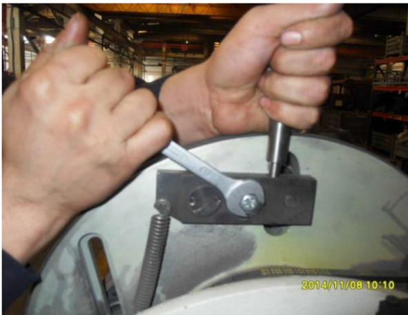
Abb. 22: Hinunterdrücken der Spannrollen
