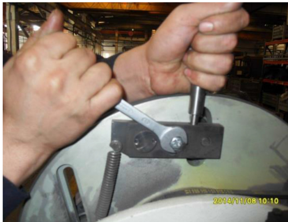
Abb. 10: Herunterdrücken der Spannrollen
