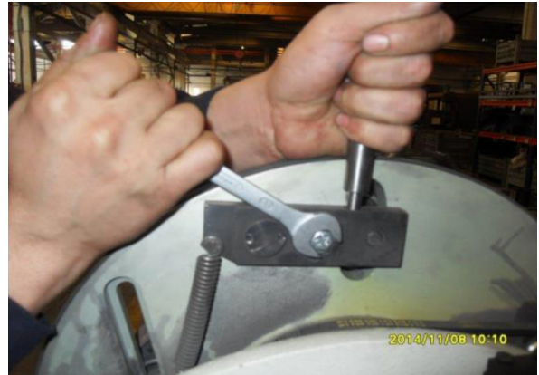
Abb. 11: Festschrauben der Spannrollen in der unteren Position
