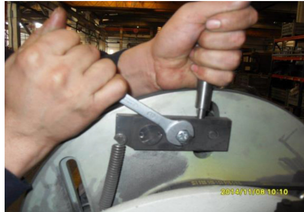
Abb. 23: Festschrauben der Spannrollen in der unteren Position
