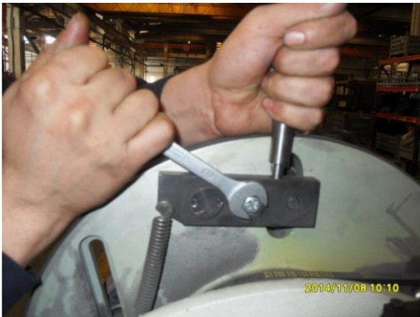
Abb. 15: Lösen der Spannrolle
