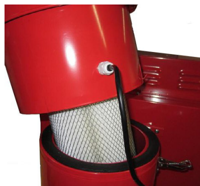
Abb. 7: Filter der Sandstrahlkabine SSK 2.5
